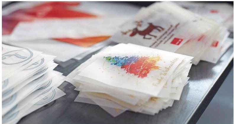
In einem Arbeitsgang hergestellte Transferdrucke: DTF-Druck.
